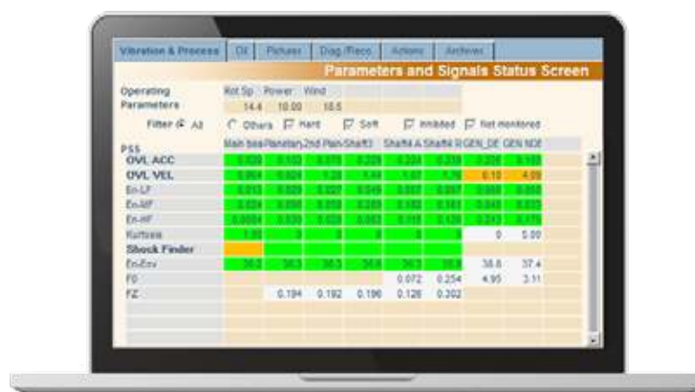
Exibição da Grade de Detecção de Defeitos (2DG) no software de análise ONEPROD NEST
